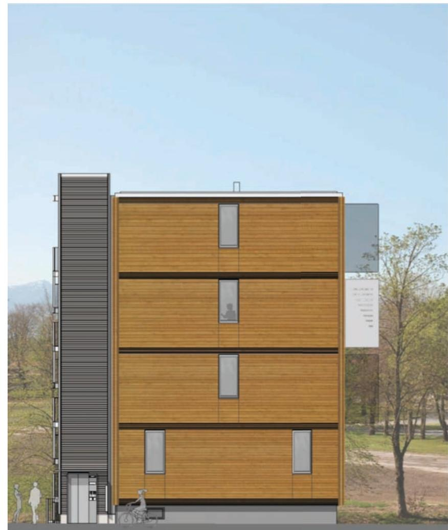
Wände, Decken, Balkone und Aufzugsschacht sind aus Holz
