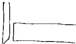
HIRNHOLZ DURCH ABDECKUNG SCHÜTZEN
