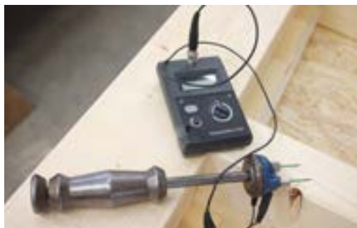
Abb. 14: Überprüfung der Holzfeuchte im Rahmen der Eigenüberwachung
