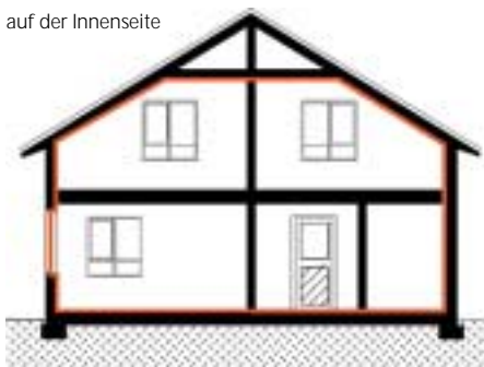
Abb. 3.1.6: Möglicher Verlauf der Luftdichtheitsebene in der Gebäudehülle.
